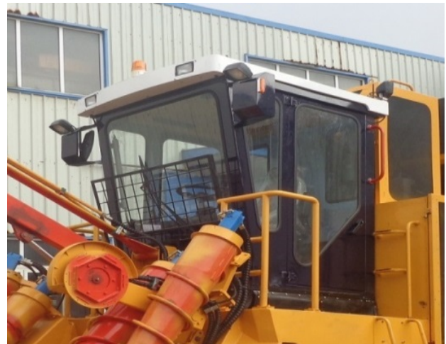
Figura 3- Cabina cosechadora de caña CCA-5000
