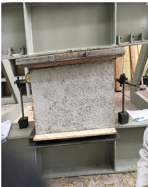
Figura 8: Dispositivo de acoplamiento para deformímetro longitudinal
