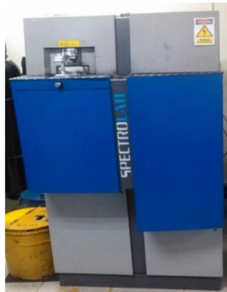
Figura 4: Equipo de espectrometría de emisiones óptica Spectrolab.
