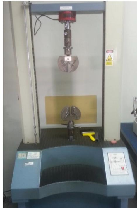
Figura 3: Máquina universal de tracción marca: YUE HUA TEC, modelo YH.
