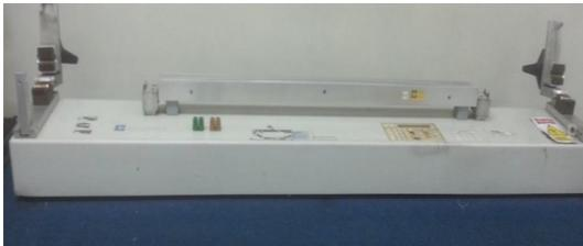
Figura 2: Puente Kelvin Marca: Aesa Cortaillod, Modelo 7106.
