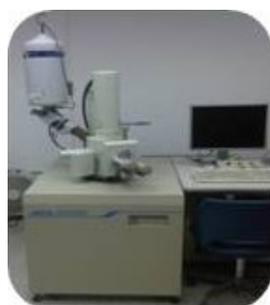
Microscopio electrónico de Barrido
