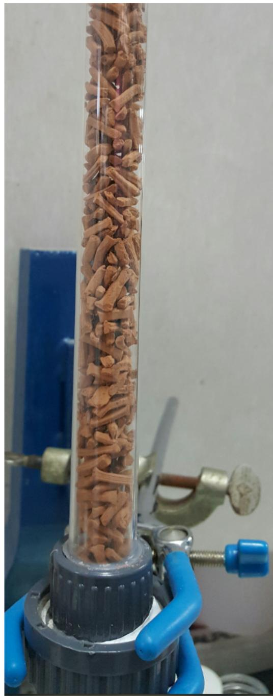
Figura 4: Columna empacada con arcillas (filtro coalescedor)
