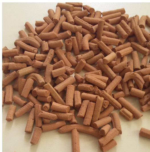
Figura 3: Cilindros de arcillas de 3 mm de largo
