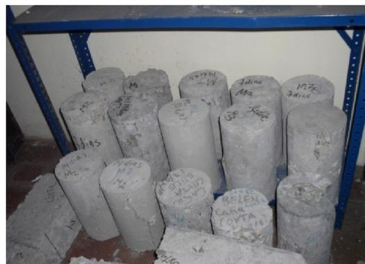
Figura 9: Concreto reforzado con fibras experimentando buena tenacidad.
