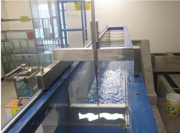
Figura 11: Medición de tirantes en modelo de laboratorio.
