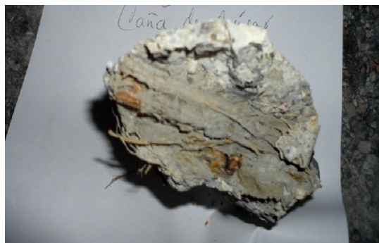
Figura 6: Impregnación incompleta de las fibras de bagazo de caña de azúcar con el PMMA.
