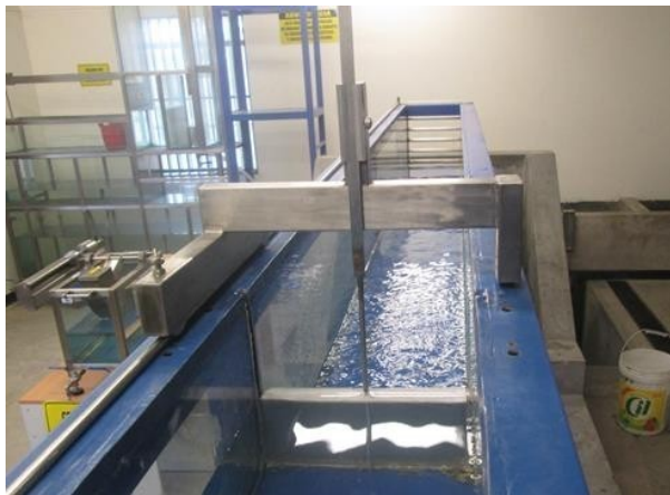
Figura 11: Medición de tirantes en modelo de laboratorio.
