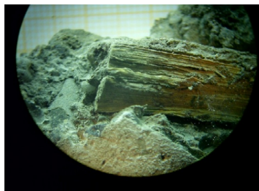
Figura 2: Mezclas de concreto reforzado con fibras de bagazo de caña de tamaño corto presentando mala adherencia.
