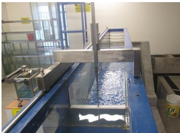
Figura 11: Medición de tirantes en modelo de laboratorio.
