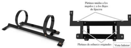
Figura 12: Representación en CAD de la estructura de sujeción “A” modificada.
