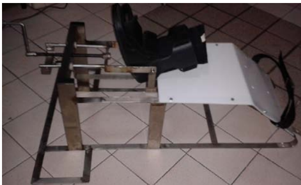
Figura 4: Pletinas y tubo rectangular de acero inoxidable 304L.
