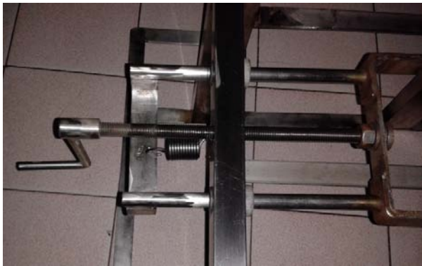
Figura 14: Traccionador de fracturas extremo inferior, mecanismo de tracción vista superior.
