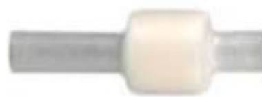
Figura 2: Minicolumna de octadecilsilano de presentación comercial C 18 clásico
