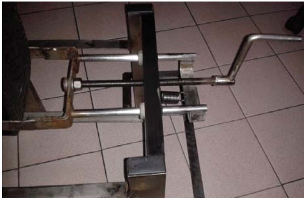
Figura 13: Traccionador de fracturas extremo inferior, mecanismo de tracción.
