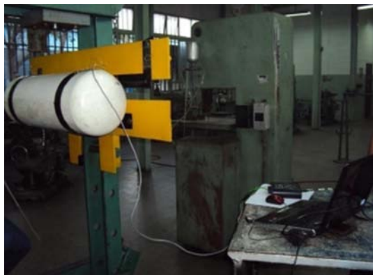
Figura 8: Ensayo de la estructura de sujeción.
