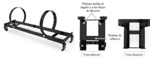
Figura 14: Representación en CAD de la estructura de sujeción “B” modificada.
