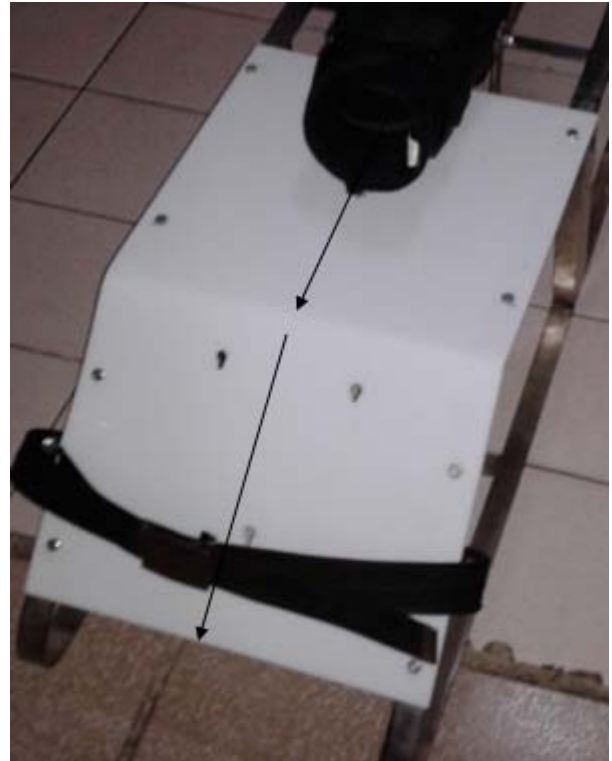
Figura 19: Soporte acrílico las flechas indican la posición exacta de la pierna.
