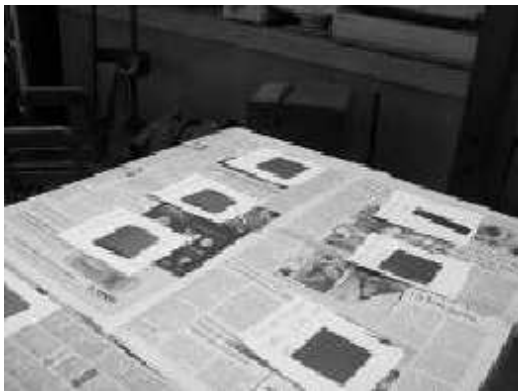
Figura 17: Chapas de acero de equipos fallados preparadas para realizar END utilizando líquidos penetrantes
