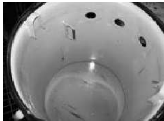
Figura 9: Apariencia del aceite dieléctrico de este transformador fallado
