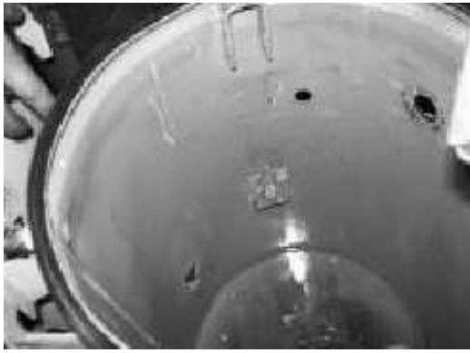
Figura 13: Apariencia del aceite dieléctrico de este transformador fallado
