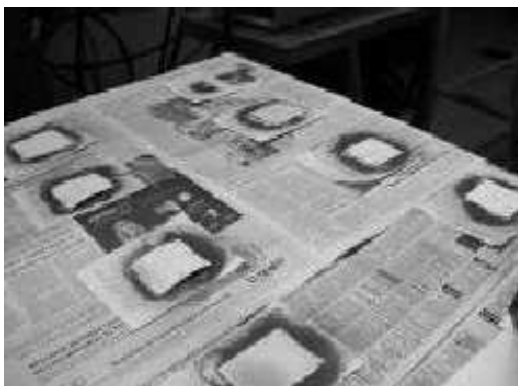
Figura 18: Chapas de acero de equipos fallados luego de aplicar líquido revelador
