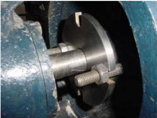
Figura 8. Detalle del apriete de los tornillos de la tapa a la brida del sello.
