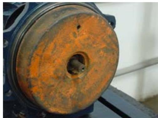
Figura 7. Tapa de la bomba montada.
