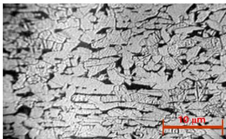
c) Deformación en frío al 10 % y recocido por 20 minutos.
