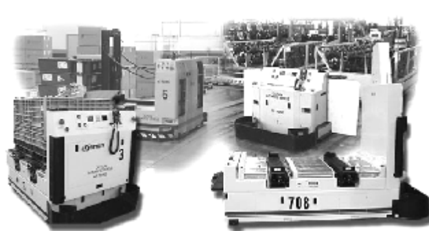
Figura 2. Tipos de AGV (Vehículos Guiados Automáticamente).
