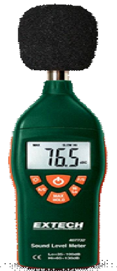
Figura 2. Equipo utilizado para medir el ruido. Sonómetro Extech 407732 (Teledyne FLIR LLC, Thousand Oaks, CA, USA).
